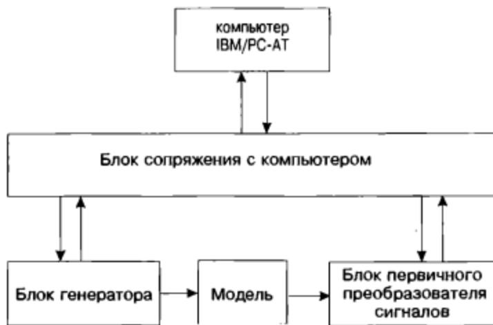
Рис. 31. Структурная схема установки для моделирования
